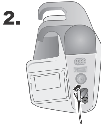
Şekil 9-1 Örnekleme Hattı Konektörünü CO 2 Giriş Portuna Bağlama
