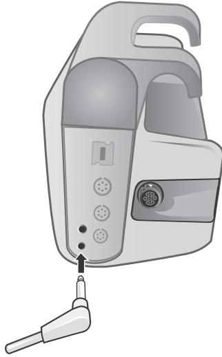
Şekil 12-1 Sıcaklık Probunu X Series Advanced Ünitesine Bağlama
