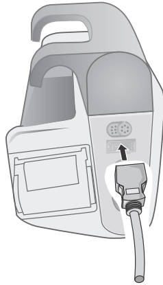
Şekil 10-3 SpO 2 Sensörünü X Series Advanced Ünitesine Bağlama
